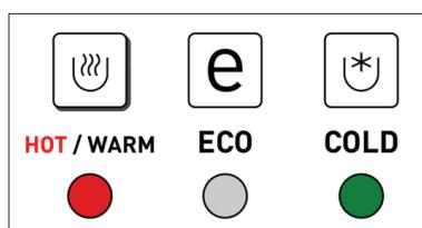
Lampica **HOT/WARM** svjetli crveno kada je aktivirana opcija grijanja vode na pozadini uređaja. Lampica **ECO** svjetli kada je smanjena aktivnost i aktivira se ušteda električne energije (solarni senzor). Lampica **COLD** svjetli zeleno kada je aktivirana opcija hlađenja vode na pozadini uređaja.
