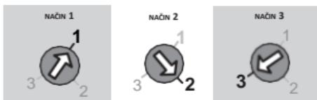
**NAČIN 1** - Podni senzor nije uzet u obzir (podešavanje prema unutarnjoj temperaturi)
