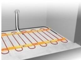
Boden und Wand müssen vor der Verlegung der Heizmatte für Kalteleiter und Temperaturfühler so aufgeschlitzt werden, dass zwei Leerrohre darin bündig versenkt werden können (**Achtung! Kaltleiter und Bodentemperaturfühler nicht im gleichen Rohr verlegen!**). Für den elektronischen Thermostat (Platzierung) sollte an der ausgewählten Stelle eine handelsübliche Unterputzdose mit 230 VAC Netzanschlussleitung aus dem Hausnetz vorhanden sein. Ein Fehlerstromschutzschalter (30 mA) ist vorzusehen.
