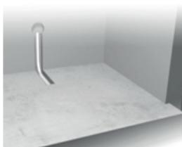
Der Boden, auf dem die Heizeinheit aufgebracht wird, muss eben, sicher, fest und ausreichend belastbar sein. Vor dem Verlegen der Heizmatte auf dem Estrich, muss der Untergrund sauber, trocken, fest, staub- und schmutzfrei sein. Sollte der Unterbau uneben sein, so ist dieser vor der Verlegung der Heizelemente zu nivellieren, sodass Hohlräume unterhalb der Heizleitung vermieden werden. Bewegungsfugen in der Unterkonstruktion dürfen auf keinen Fall mit dem Flächenheizelement überbrückt werden.
