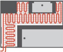
Fixieren Sie die Elektro-Comfort-Dünnbetttheizung gemäß Ihrem Verlegeplan mit der Klebeseite auf dem Untergrund. Schneiden Sie an der vorgesehenen Wendestelle das Glasfasergewebe ein (**Achtung! Heizleitung nicht beschädigen!**) und verlegen Sie die Heizmatte, wie in der Illustration dargestellt.
